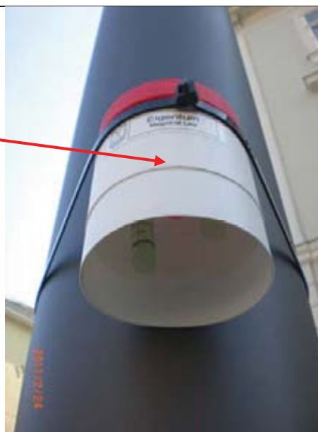
Grafik 25: Passivsammler in Wetterschutzhaube Anmerkung: Wetterschutzhaube ohne Insektenschutz
