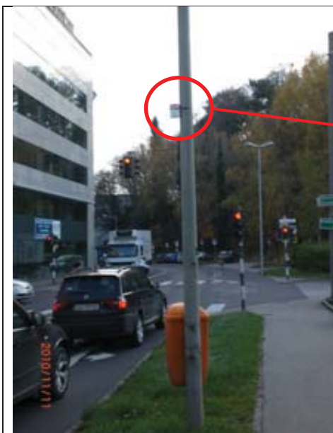
Grafik 24: Messpunkt mit Wetterschutzhaube und Sammler Charakter / Kategorie: überwiegend verkehrsbelastet
