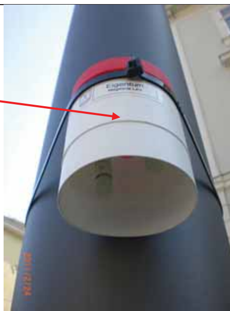
Grafik 27: Passivsammler in Wetterschutzhaube Anmerkung: Wetterschutzhaube ohne Insektenschutz
