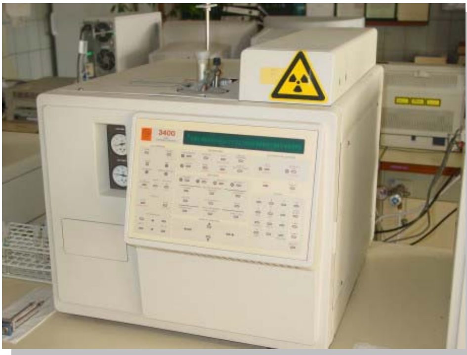
Foto 3: Gaschromatograph mit radioaktivem Detektor (sogenannten Elektronen-Einfang-Detektor)
