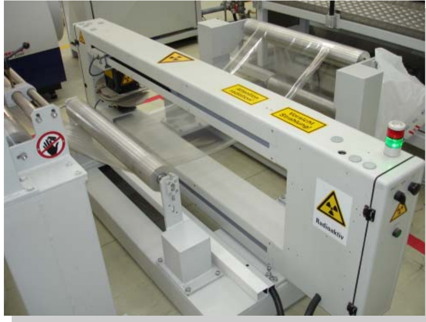
Foto 1: Radioaktive Messanlage zur Messung der Foliendicke
