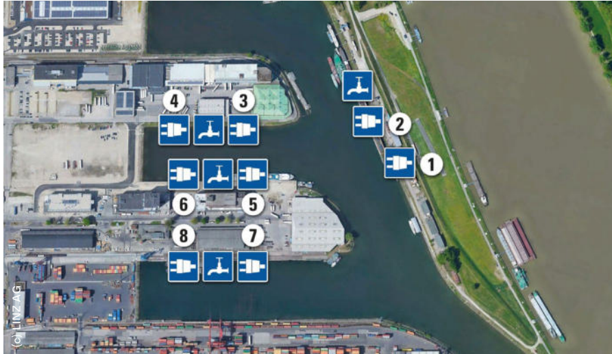
Der Handelshafen verfügt mittlerweile über acht Landstromstationen zur emissionsfreien Versorgung der Binnenschiffe während ihres Aufenthaltes.
