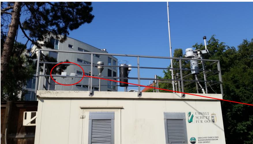
**Bild 4:** Situierung der Staubsensoren bei der ortsfesten Immissionsmessstation S431 Linz-Römerberg
