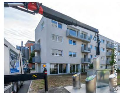
Die Entleerung der Behälter funktioniert mit einem speziellen Kransystem.
