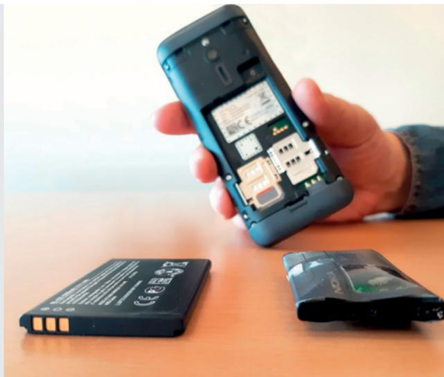
und Akkus nie vollständig entladen, sind sichtbare offene **Pole** vor Entsorgung mit **einem Klebeband abzukleben**, um Kurzschlüsse zu vermeiden. Es sollten außerdem zum Aufladen von Akkus nur **Original-Ladegeräte und -Zubehör** verwendet werden. Ladevorgänge dürfen keinesfalls in der Nähe von **brennbaren Gegenständen (z. B. Decke, Papier)** oder ohne Aufsicht stattfinden.
