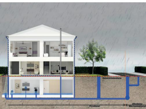
**Auch, wenn das** Kanalnetz von LINZ AG ABWASSER nach dem aktuellsten Stand der Technik dimensioniert ist, kann es bei Verstopfungen oder starkem Platzregen zu einem Kanalarückstau kommen. „Dieser führt in ungeschützten Räumen, die unter der Rückstauenebene liegen, zu Überflutungen und damit zu Schäden
