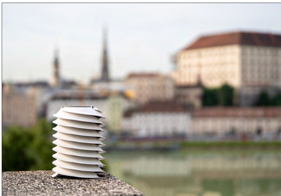
Abbildung 61 – Messstation Meteohelix der Firma Barani, Foto: Horak.
