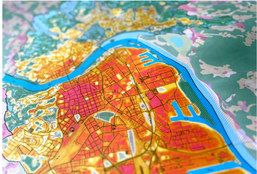
Abbildung 37 – Auszug der Klimaanalysekarte, einer zentralen Sachgrundlage für stadtklimatologische Stellungnahmen.
