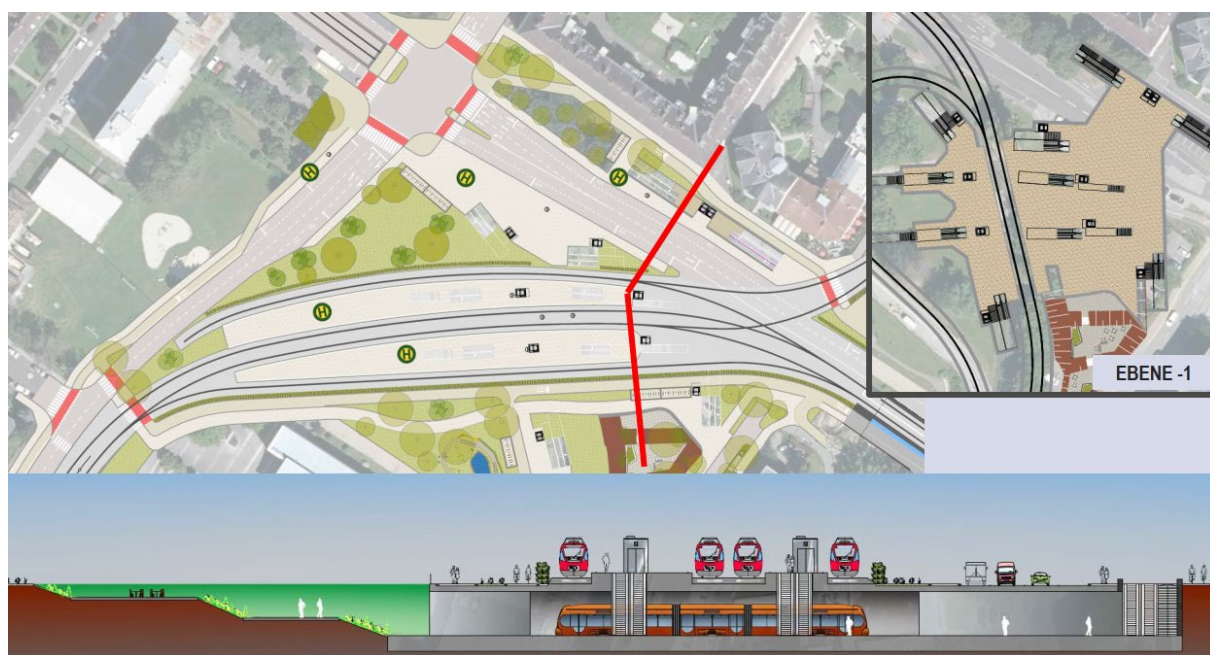
Abbildung 1: Unterirdische Führung der Straßenbahn und oberirdische der Stadtbahn Quelle: ILF
