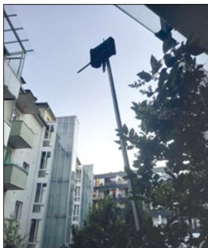
Abb. 1 u. 2: Batcorder sind Geräte, die Fledermausrufe automatisch aufnehmen und speichern können.
