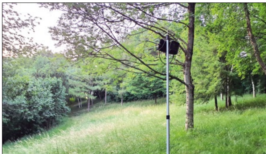
Abb. 1 u. 2: Batcorder sind Geräte, die Fledermausrufe automatisch aufnehmen und speichern können.
